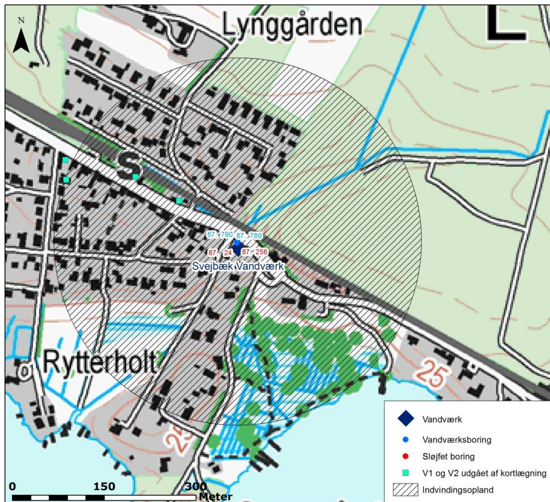
Figur 3.1 Svejbæk Vandværks indvindingsopland med placering af vandværket, boringer og forurenede grunde.
